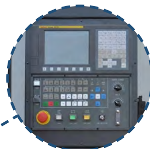
Система управления FANUC Oi Mf(5) Plus
