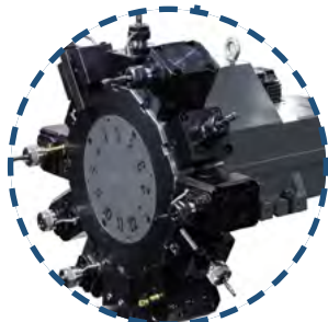
Револьверная головка ВМТ55 (с приводом)
