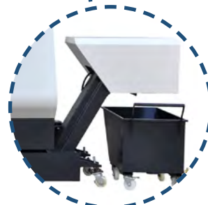
Автоматический конвейер для стружки
