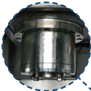
Шпиндель BT40 (11/15 кВт, 12000 об/мин)
