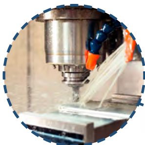
Система подачи СОЖ через шпиндель (30 бар)
