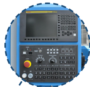
Система управления FANUC Oi Mf(5) Plus
