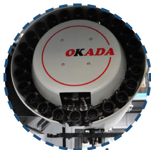
Автоматическая смена инструмента (24 позиции)
