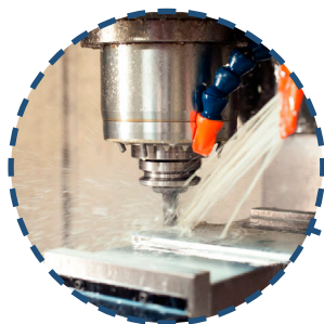
Система подачи СОЖ через шпиндель (30 бар)
