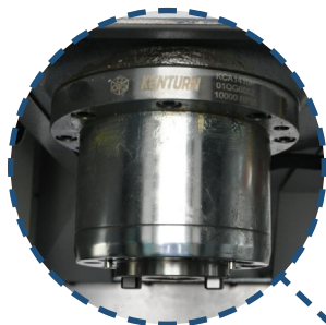
Шпиндель BT40 (11/15 кВт, 12000 об/мин)
