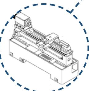
Цельнолитная станина из серого чугуна (Mehanit)
