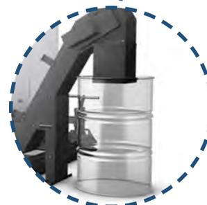
Автоматический конвейер для стружки
