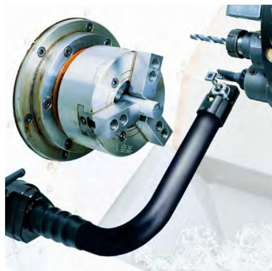
Запатентованное поворотное устройство обеспечивает фиксацию руки с высокой повторяемостью позиционирования. Никаких дополнительных устройств регулировки или фиксации при этом не требуется. В дополнение к своим высоким характеристикам рука НРМА занимает очень мало места на станке благодаря компактной конструкции.
