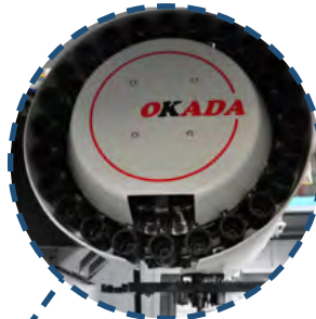
Автоматическая смена инструмента (24 позиции)
