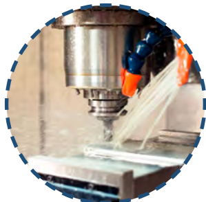
Система подачи СОЖ через шпиндель (30 бар)
