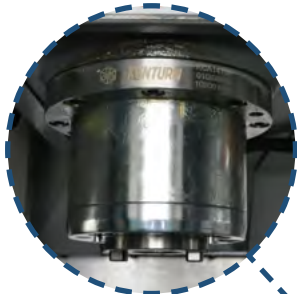
Шпиндель ВТ40 (11/15 кВт, 12000 об/мин)
